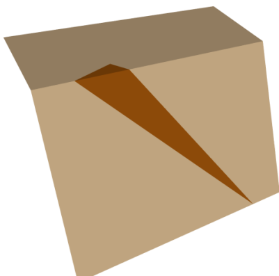
Figur 15. Kil vid slutgiltig slänt i öst. Värsta fall.
