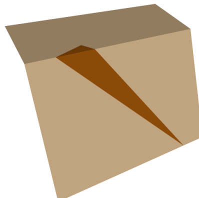
Figur 16. Kil vid slutgiltig slänt i öst. Normalt fall.
