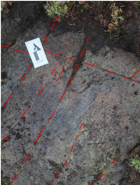
Figur 2.6 förtydligande av sprickor i håll, norrpil med skala ligger mot faktiska norr ( \pm 10 grader).
