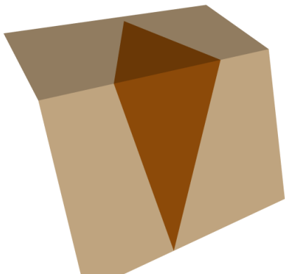
Figur 11. Kil vid slutgiltig slänt i norr. Värsta fall.
