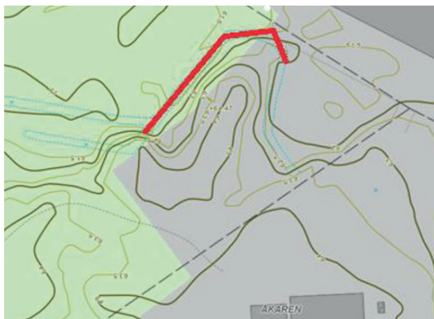
Bild: Dike med förhöjda halter där massor ej sanerats är markerat med rött (Sammanställning av utförda åtgärder vid fastigheten Säfte 6:18, Sweco 2020)
