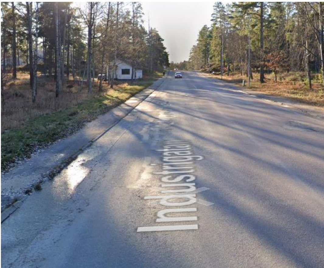
Figur 7 Industrigatan, bred körbana och smala gångbanor på båda sidor. (Källa: Google maps)
